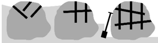
Se un masso è per lo più sotto il livello del suolo, la perforazione ad angolo è più efficace. Altrimenti si dovrebbe perforare verticalmente. **Perforare il 90% del masso.**
