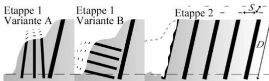
Zuerst mit kurzen Löchern (Variante A + B) den Sockel abtragen, sodass eine grosse freie Fläche entsteht. In der 2. Etappe alle 5 bis 15 Stunden eine weitere Reihe abfüllen.
