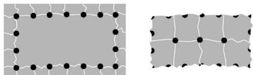
Um Stahlbetonobjekte in kleine Elemente zu zerlegen, wird als Erstes nur eine einzelne Reihe von Bohrlöchern im Abstand von 4 x Bohrlochdurchmesser von der Objektkante entfernt angeordnet und verfüllt. Wenn die Bewehrung freigelegt ist, wird der übrige Beton wie oben beschrieben abgebohrt und verfüllt.
