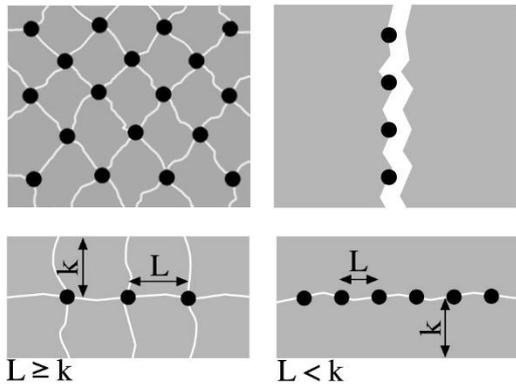
Wenn Trümmerteile mit Handwerkzeug abtransportiert wird, sollten die Abstände zwischen den Bohrungen 30 cm nicht überschreiten. Wenn der Schutt mit Bagger abgetragen wird, kann der Abstand grösser gewählt werden.
