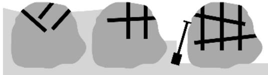
Liegt ein Stein grösstenteils unter der Erdoberfläche, sind Winkelbohrungen am effektivsten. Ansonsten sollte vertikal gebohrt werden. **Stein zu 90 % durchbohren.**
