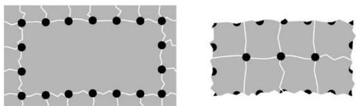
Per suddividere gli oggetti di cemento armato in piccoli elementi, viene prima disposta e riempita una sola singola fila di fori a una distanza di 4 volte il diametro della punta del trapano dal bordo dell'oggetto. Quando l'armatura è a vista, il cemento rimanente viene perforato e riempito come descritto sopra
