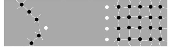
L'espacement des trous (de maille carré) S ne doit jamais dépasser la profondeur du trou D. En outre, l'espacement des trous ne doit pas dépasser (pour les roches dures / molles) :
