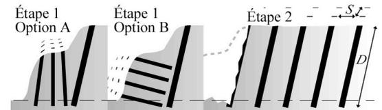
Profondeur de forage: 80 à 85% de la hauteur du bloc.
