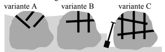
Les trous inclinés forment une rupture dans une couche de béton ou de roche. La poussée de la partie détachée vers le haut (vers la surface libre horizontale) crée deux surfaces libres supplémentaires en pente :
